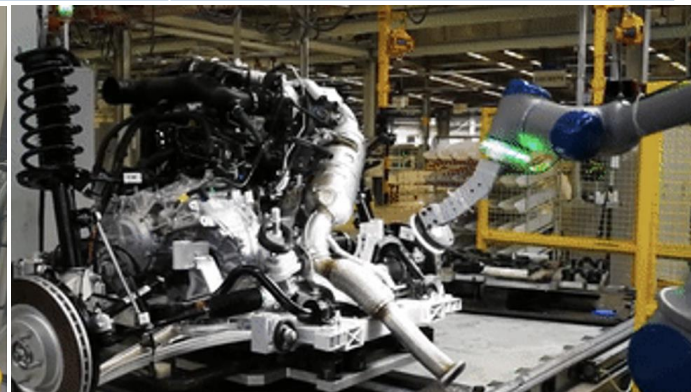
6. 车桥传感器, 线束插头视觉检测
