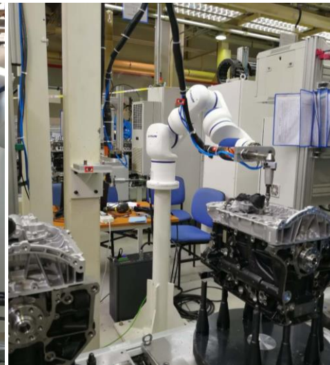
4. 机油泵和吸油管螺栓终拧紧
